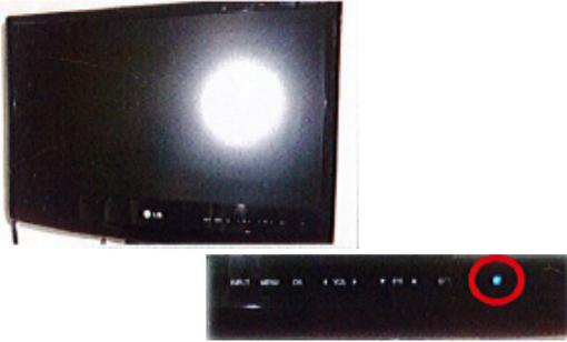
**Etape 1:** Allumez la TV en posant le doigt sur la touche marche/arrêt de la TV (le bouton est tactile, pas besoin d'appuyer) ou en appuyant sur le bouton marche/arrêt de la télécommande.
